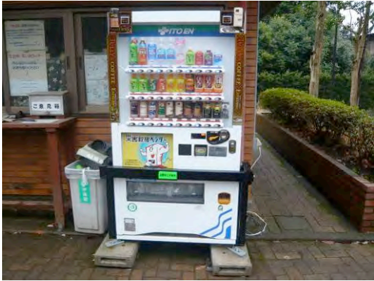
図 飲み物自動販売機の基礎部の水平移動
