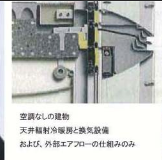
ドイツのダブルスキン事例(外:強化ガラス、内:Low-eガラス(アルゴン封入)=水平マリオン部のエアフロー⇒ドイツ:年間の65%換気のみで可能(空調レス) vs日本は年間の25%
