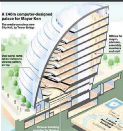
南面日射による熱取得の抑制のため、南にオーバーハングするフォルム・外皮面積を極小化する球面形状
