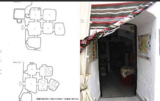
外気に面する表面積の最小化と地中との熱交換による室温維持
